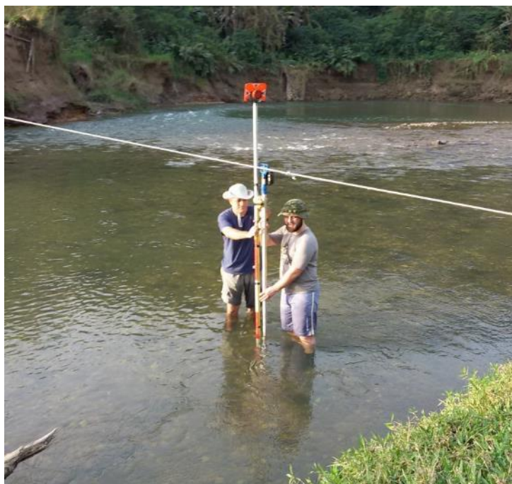
Figura 32: Realização de medições de profundidade e velocidade ao longo da referência transversal.
