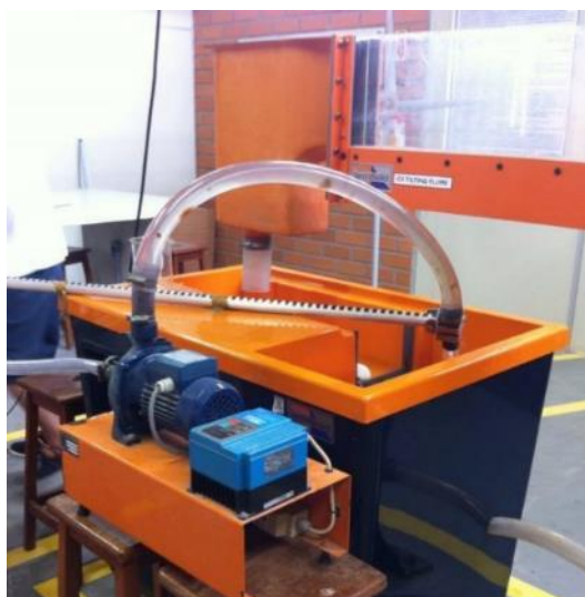
Figura 14: Calibração do molinete utilizando bomba de recalque.
